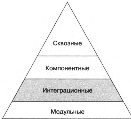
Рис. 10.2. Интеграционные тесты находятся на уровень выше модульных. Они проверяют, может ли сервис взаимодействовать со своими зависимостями, включая инфраструктурные компоненты наподобие базы данных и другие сервисы приложения
