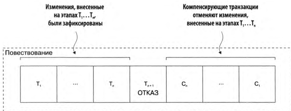
Рис. 4.3. Когда этап повествования завершается неудачей в результате нарушения бизнес-правила, повествование должно вручную отменить все обновления, сделанные на предыдущих этапах, выполнив компенсирующие транзакции
