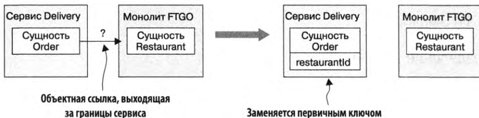
Рис. 13.6. Объектную ссылку на Restaurant внутри класса Order заменяют первичным ключом, чтобы избавиться от объекта, выходящего за пределы процесса
