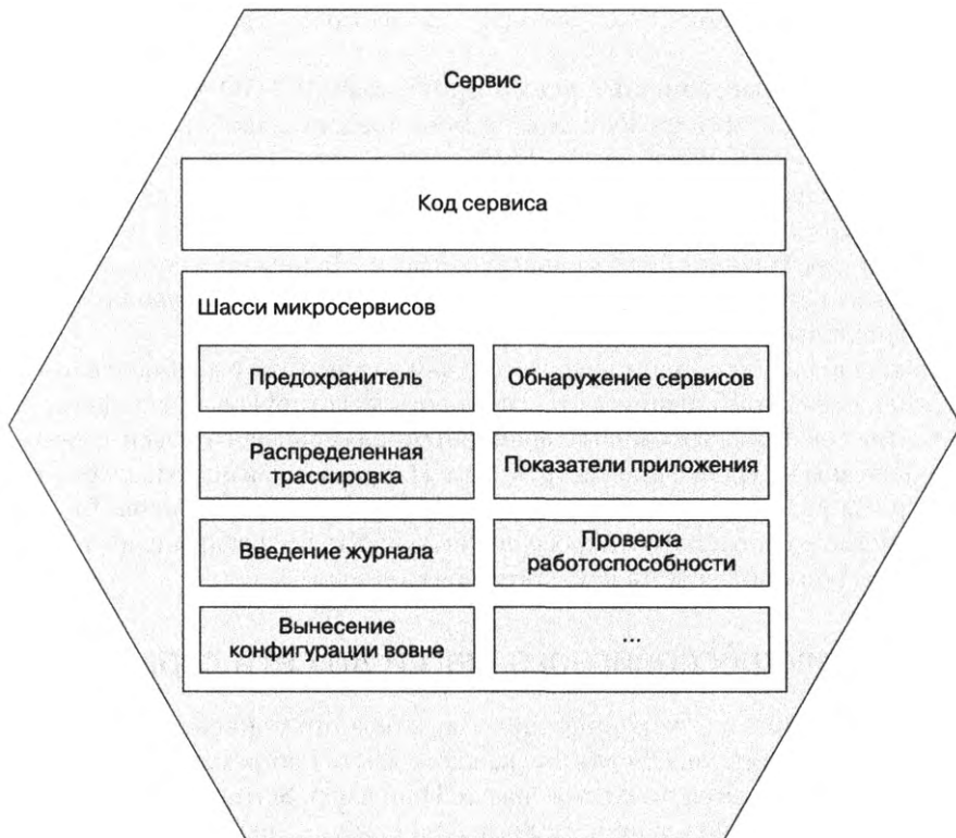
Рис. 11.16. Шасси микросервисов — это фреймворк, который берет на себя многочисленные обязанности, такие как отслеживание исключений, ведение журнала, проверки работоспособности, работа с внешней конфигурацией и распределенная трассировка
