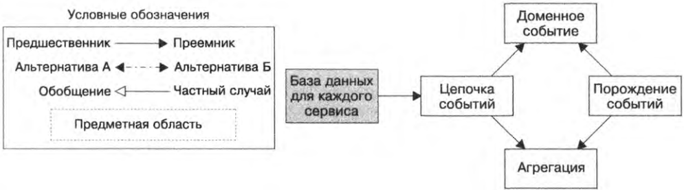
Рис. 1.13. Поскольку каждый сервис работает с собственной БД, для согласования данных между разными сервисами требуется шаблон «Повествование»
