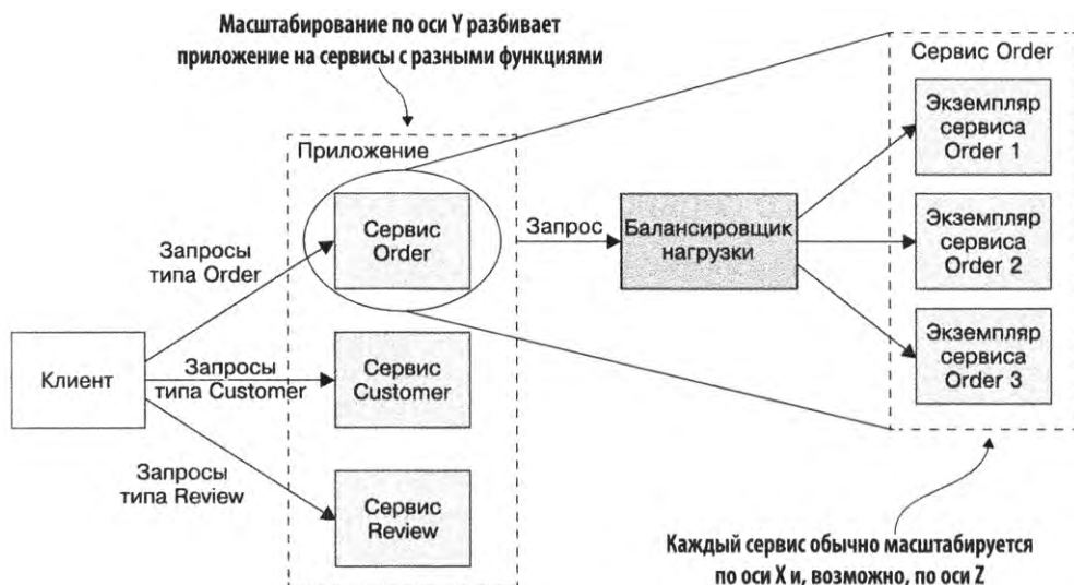
Рис. 1.6. Масштабирование по оси Y разбивает приложение на отдельные сервисы. Каждый из них отвечает за определенную функцию и масштабируется по оси X (а также, возможно, по оси Z)
