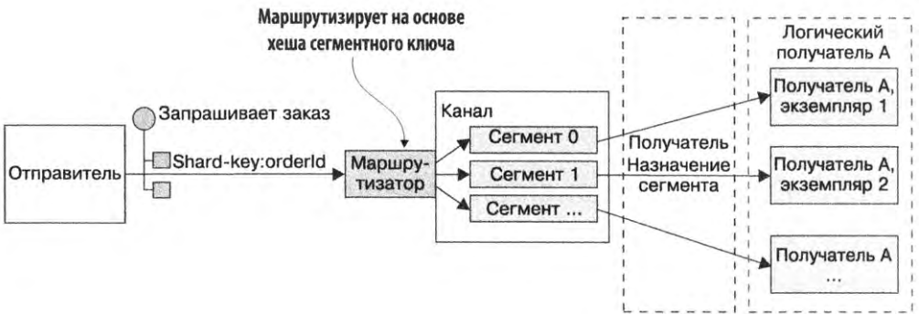
Рис. 3.11. Масштабирование потребителей с использованием сегментированного (разделенного) канала, чтобы сохранить порядок следования сообщений. Отправитель включает в сообщение ключ сегмента. Брокер записывает сообщение в сегмент, определенный на основе этого ключа, и назначает каждый раздел экземпляру реплицированного получателя
