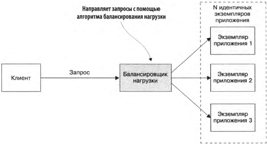
Рис. 1.4. Масштабирование по оси X связано с запуском нескольких идентичных экземпляров монолитного приложения, размещенных за балансировщиком нагрузки
