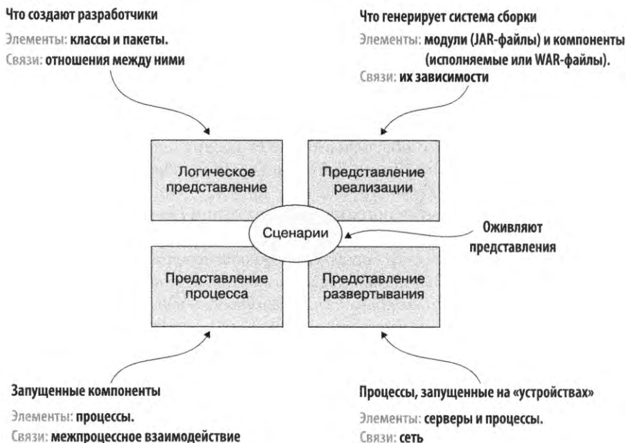
Рис. 2.1. Модель представлений вида 4 + 1 описывает архитектуру приложения с помощью четырех представлений и сценариев, которые показывают, как элементы внутри каждого представления взаимодействуют для обработки запросов
