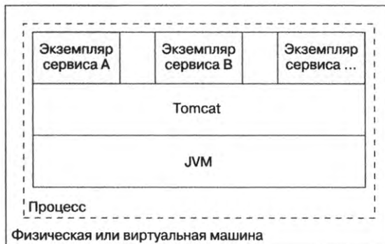
Рис. 12.5. Развертывание нескольких экземпляров сервиса в одном и том же веб-контейнере или сервере приложений. Эти экземпляры могут принадлежать одному и тому же или разным сервисам. Ресурсы операционной системы распределяются между экземплярами. Но поскольку они запущены в одном процессе, то никак не изолированы
