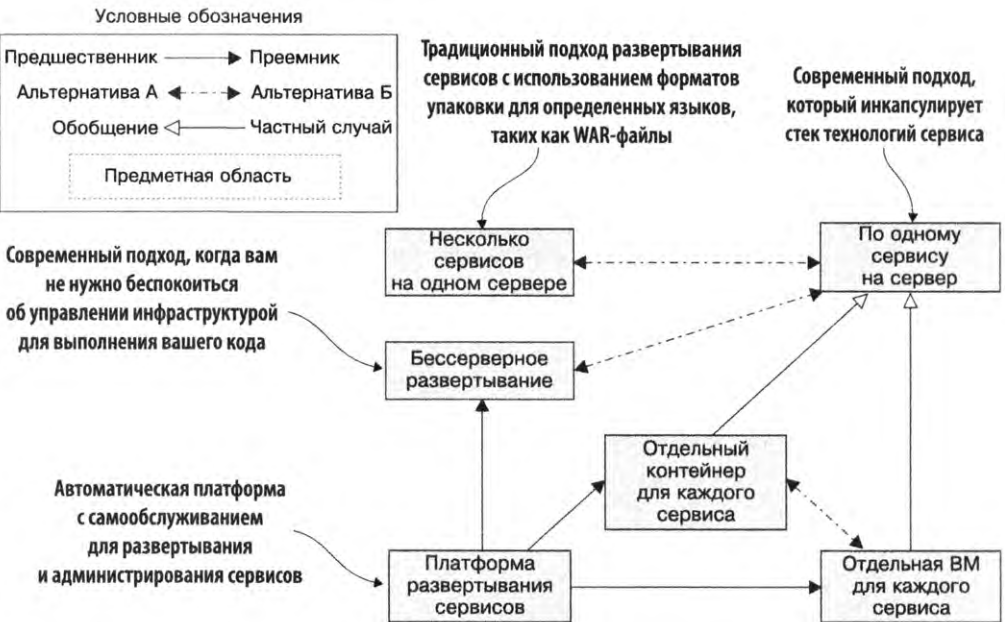
Рис. 1.15. Несколько шаблонов развертывания микросервисов. Традиционный подход состоит в развертывании сервисов в формате упаковки определенного языка. У него есть две современные альтернативы. Первая — развертывание сервисов в виде виртуальных машин (VM) или контейнеров. Вторая — бессерверные технологии: вы просто загружаете свой код, а бессерверная платформа его выполняет. Следует использовать автоматизированную платформу с поддержкой самообслуживания для развертывания и администрирования сервисов
