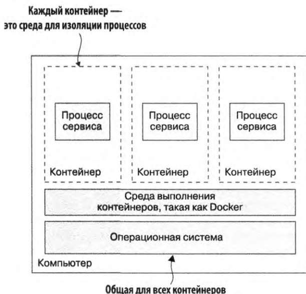
Рис. 12.7. Контейнер состоит из одного или нескольких процессов, запущенных в изолированной среде. На одном компьютере обычно запускается несколько контейнеров, использующих общую операционную систему
