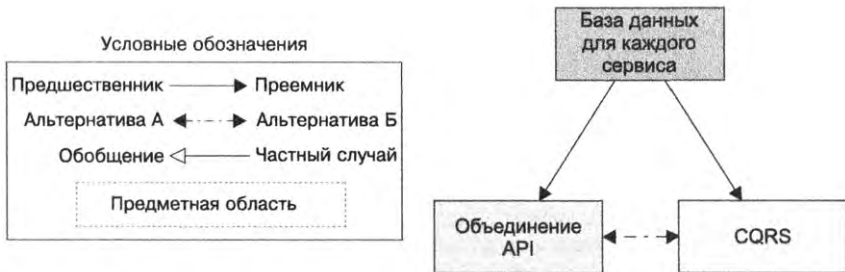
Рис. 1.14. Поскольку каждый сервис работает с собственной БД, для извлечения данных, разбросанных по нескольким сервисам, следует использовать один из шаблонов запросов
