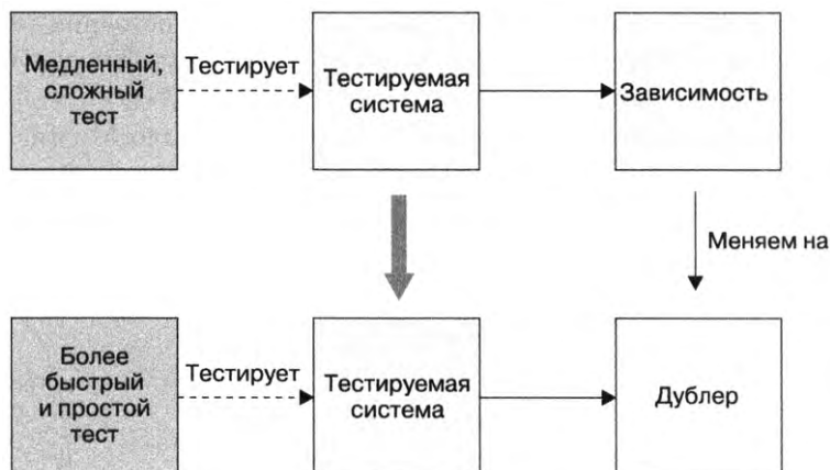
Рис. 9.3. Замена зависимости дублером, который позволяет тестировать систему в изоляции. Тест получается более простым и быстрым
