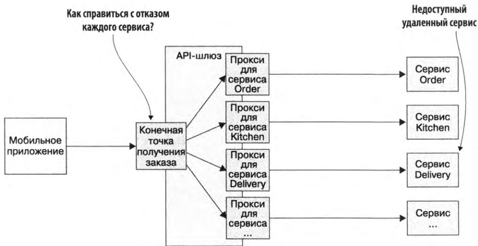
Рис. 3.3. API-шлюз реализует конечную точку GET /orders/{orderId} путем объединения API. Он вызывает несколько сервисов, агрегирует их ответы и возвращает результат мобильному приложению. Код, реализующий конечную точку, должен иметь стратегию на случай отказа любого из сервисов, которые он вызывает
