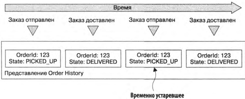
Рис. 7.11. События DeliveryPickedUp и DeliveryDelivered доставляются два раза, из-за чего в представлении временно рассинхронизируется состояние заказа
