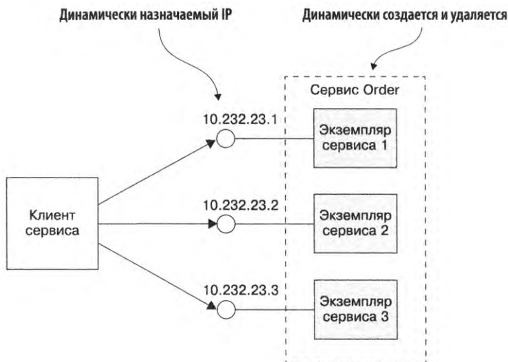
Рис. 3.4. Экземпляры сервисов имеют динамически назначаемые IP-адреса
