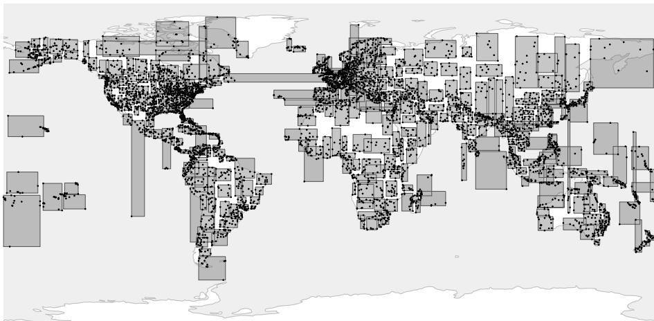
Рисунки показывают структуру индекса, созданного 13-й версией PostgreSQL. Версия 14 предварительно сортирует точки в z-порядке<sup>1</sup> – это дает существенный выигрыш в скорости построения индекса, но увеличивает перекрытия прямоугольников (и снижает эффективность поиска). В версии 15 алгоритм сортировки был существенно улучшен<sup>2</sup>, но прежние рисунки остаются более наглядными.
